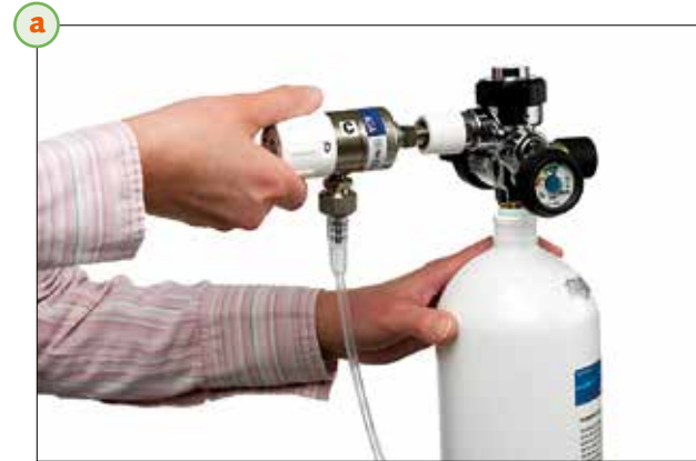
a) Tarkista, että virtaussäätimen säätönuppi on 0-asennossa. Kytke virtaussäädin happipullossa olevaan pikaliittimeen.
