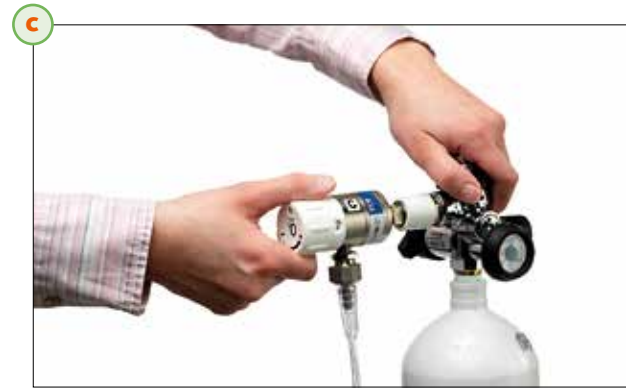
c) Aseta oikea virtaus kääntämällä säätönuppia. Varmista, että kuulet nupin lukittuvan paikalleen, kun virtaus asetetaan. Varmista aina, että säätönuppi on oikeassa asennossa eikä kahden arvon välissä. Jos näin käy, virtaussäädin ei syötä oikeaa kaasun virtausta.
